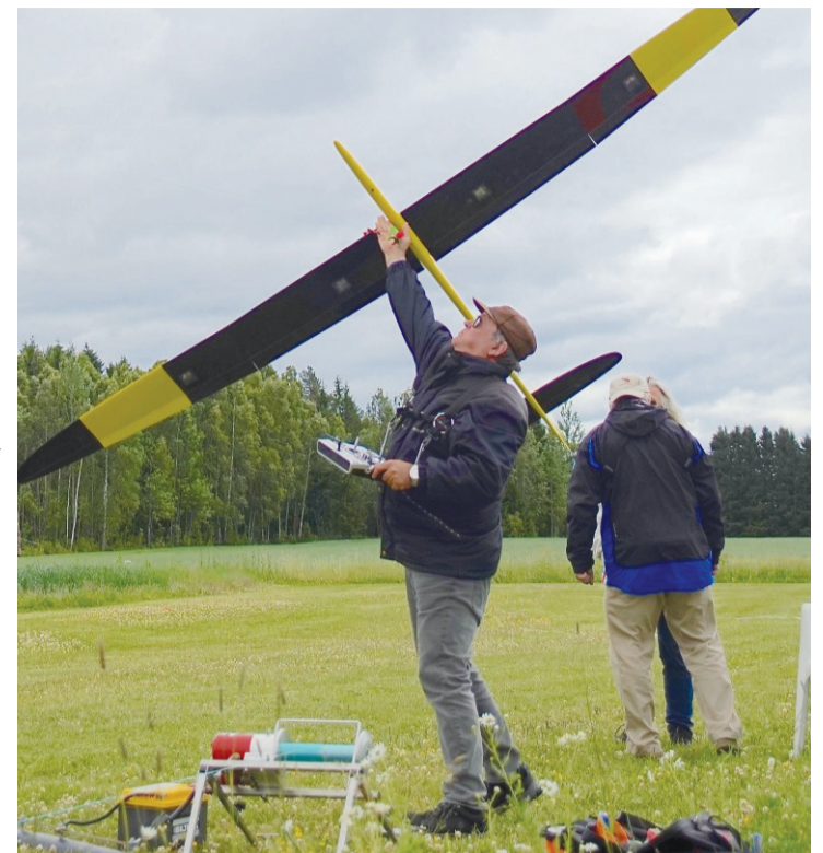
Dette seilflyet er støpt i karbon og har et vingspenn på nesten fire meter. Det dras opp i luften med en line på en vinsj som drives av et bilbatteri, og har en pedal for start og stopp. Flyet dras hundre meter opp i luften i løpet av åtte sekunder og når linen droppes fortsetter flyet opp i 200 meters høyde på den energien som finnes i flyet.
